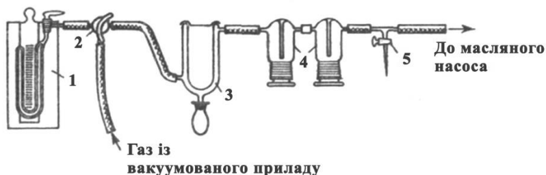
Рис. 8.4. Схема збірки вакуумної системи:
