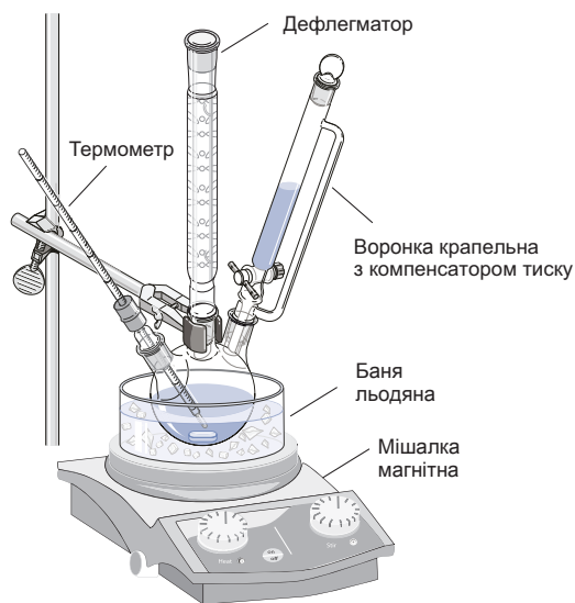
Рис. 4.3. Круглодонна тригорла колба (оснащена крапельною воронкою, дефлегматором і термометром для контролю температури реакційного середовища), на магнітній мішалці в льодяній бані
