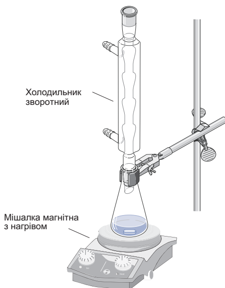
Рис. 1.14. Нагрівання та перемішування в конічній колбі зі зворотним кульковим холодильником за допомогою магнітної мішалки
