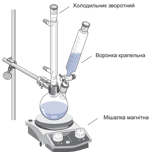
Рис. 5.1. Круглодонна двогорла колба, оснащена крапельною воронкою та зворотним холодильником, на магнітній мішалці
