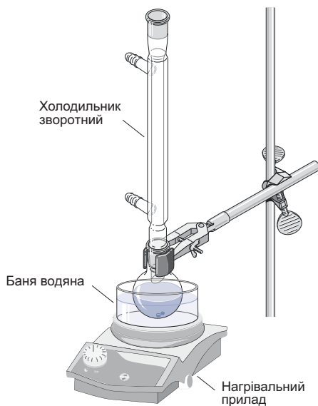
Рис. 1.8. Нагрівання круглодонної колби зі зворотним холодильником у водяній бані
