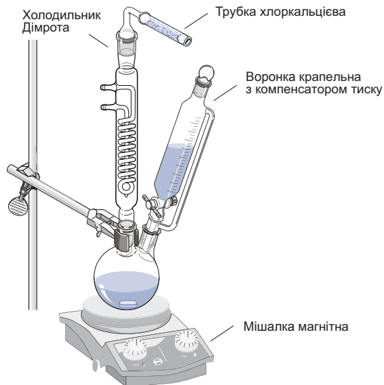
Рис. 6.2. Круглодонна двогорла колба, оснащена крапельною воронкою та зворотним холодильником Діброта з хлоркальцієвою трубкою, на магнітній мішалці
