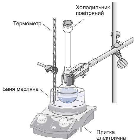
Рис. 9.2. Нагрівання круглодонної колби з дефлегматором у масляній бані з контролем температури бані
