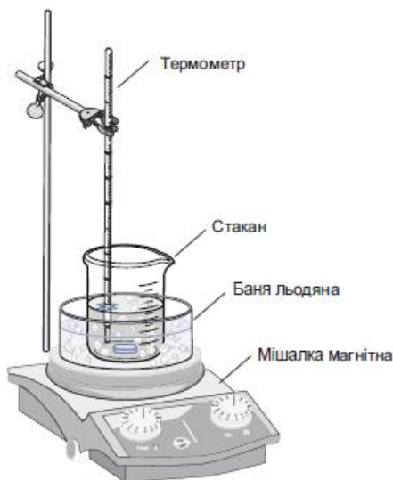
Рис. 3.1. Перемішування в стакані, що вміщений у водяну (льодяну) баню, і контроль температури розчину
