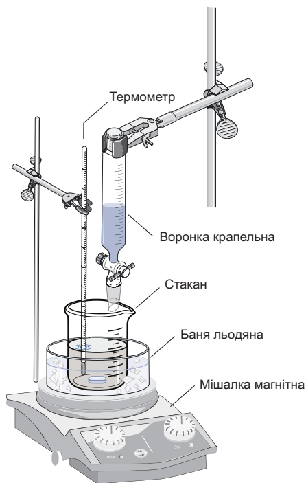
Рис. 7.3. Перемішування у стакані, що охолоджується в льодяній бані, з одночасним додаванням реагента із крапельної воронки та контролем температури реакційної суміші
